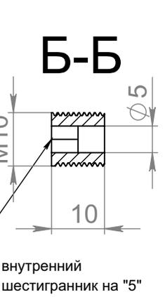
На 225 и 145 отступе в тыльной части вместо отверстия  $\phi 5$ мм нарезана резьба M10 и закручен установочный винт M10x10мм
