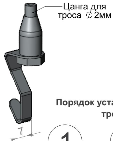
Порядок установки и регулировки
