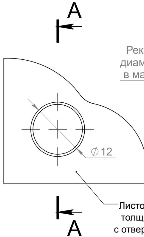
Рекомендуемый диаметр отверстия в материале 9 мм
